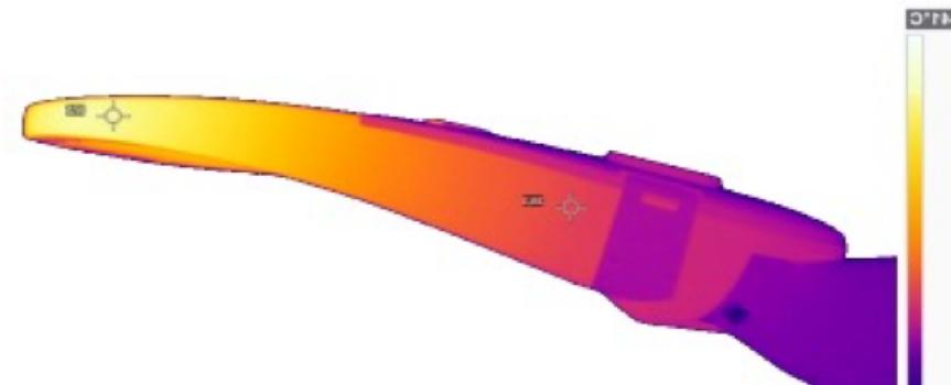
La température du luminaire n'excède pas 41°C sur son enveloppe externe. Le contact direct du circuit LED sur la mécanique, assure une température de fonctionnement maximum de 50°C au niveau des LED, et côté alimentation, la température de contact ainsi que la température ambiante n'excèdent pas 25-30°C.
